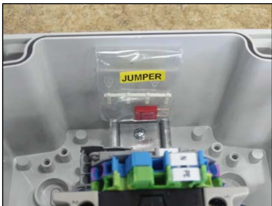
Pribalený mostík a záslepka v rozvodnej krabici
